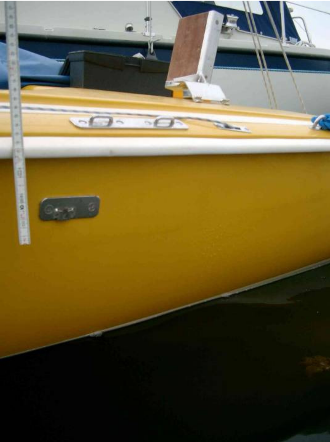
Faste beslag på båden, bemærk slidsen på sidebeslaget som bolten med fløj møtrikken kan glide ned i.
