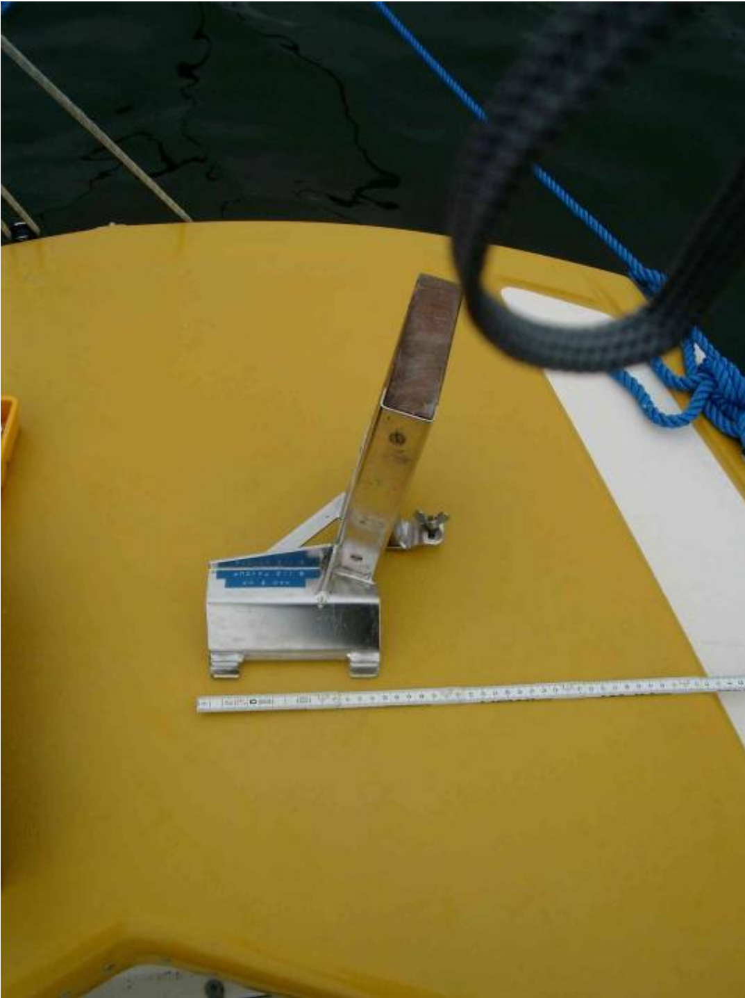
Beslaget fæstes med 2 "bøjler" (flækket rør der er svejset til beslaget) til dæksbeslaget.
